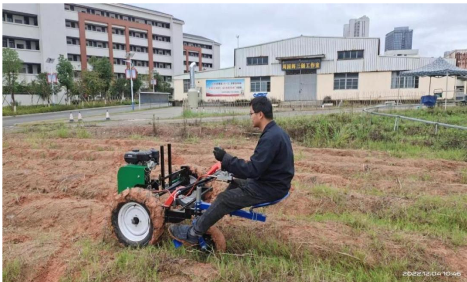
图 11 三明市农业学校教师周国辉研制“基于山地丘陵高地垄的小型化底盘平台”
